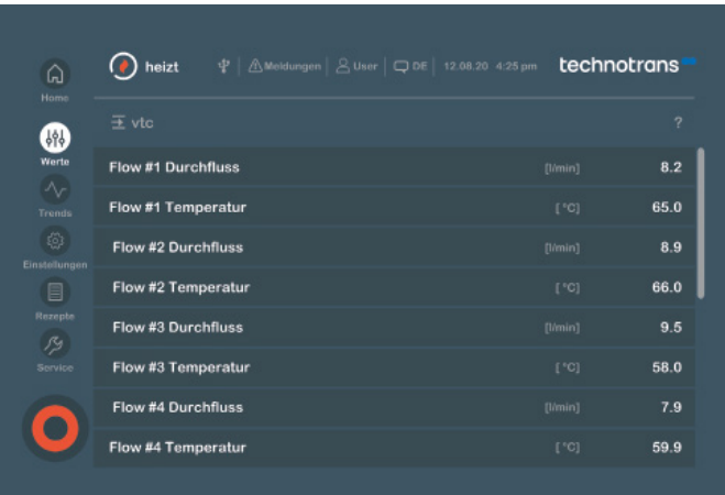
Anzeige und Bedieneinheit logotherm mit 7" Multitouch-Display
