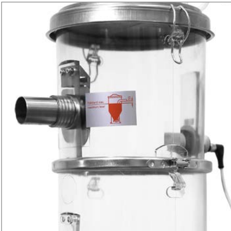
Möglichkeit, den Vakuum- und Materialeinlass unabhängig voneinander auszurichten
