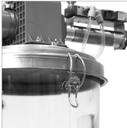
Schnelle und einfache Wartung dank des transparenten Gehäuses und der Schnellverschluss-Scharniere
