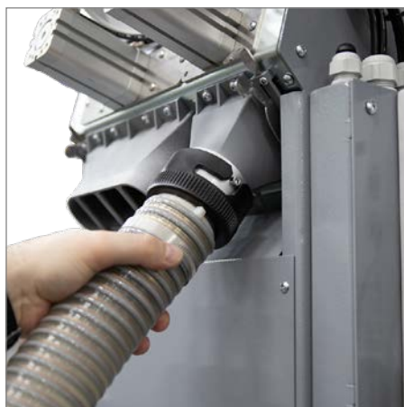
Schnellentleerung für die vollständige Entleerung der Verweiltrichter
