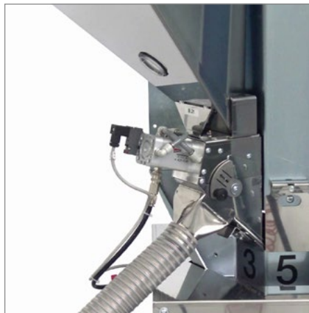
Schnellentleerung für die vollständige Entleerung der Verweiltrichter
