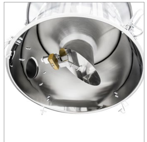
Die interne Klappe wird durch den Vakuumeffekt geschlossen
